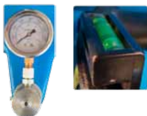
indicateur de charge et niveau à bulle
