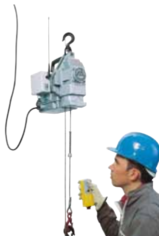
radiotélécommande pour Minifor™
